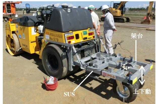
図-1 締め固め測定機
