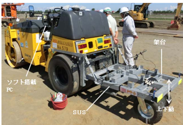
図-3 衝撃加速度法一連続測定システム
