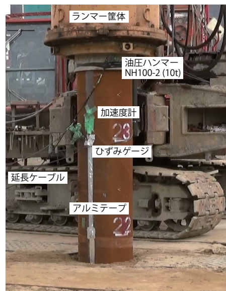
図－２ 加速度計およびひずみゲージの設置状況
