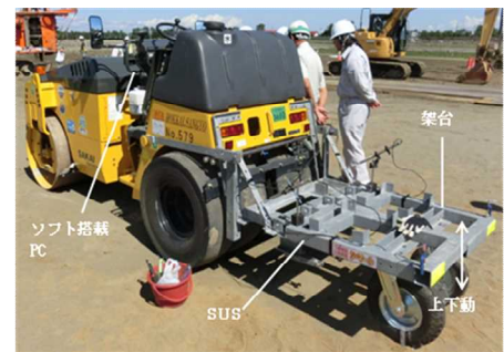
図-1 衝撃加速度法—連続測定システム
