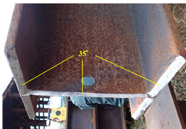
写真-1 先端抵抗低減杭
