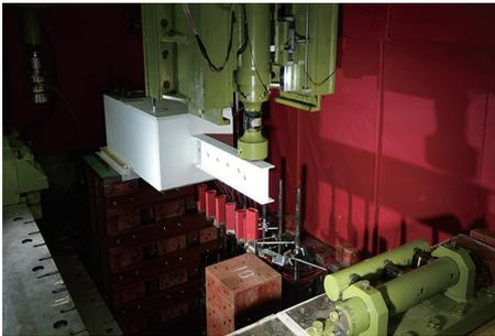
(b) 重錘落下衝撃荷重実験
