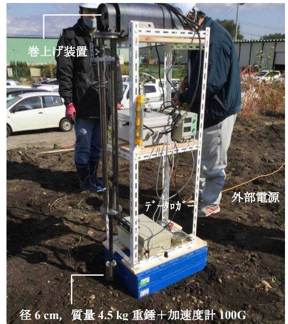
図-2 重錘落下機構
