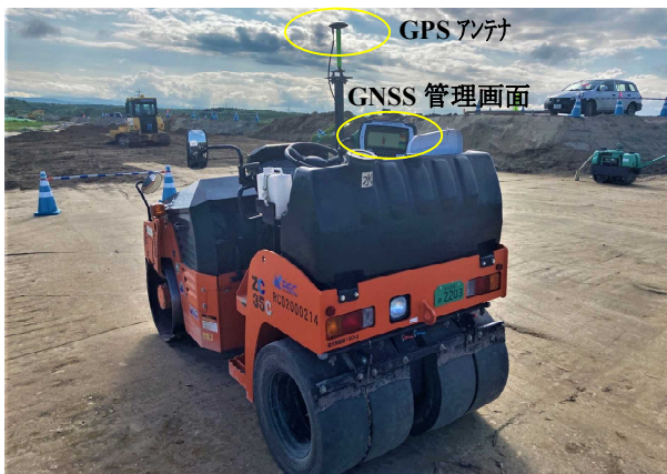
図-1 GNSS 管理を装備したローラー
