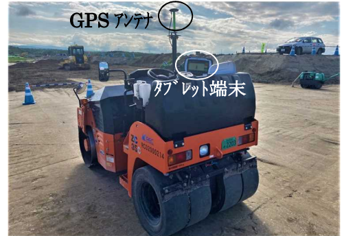
図-1 GNSS 管理を装備したローラー
