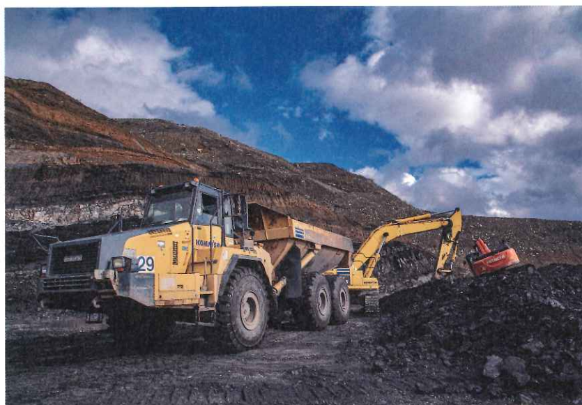
コマツの油圧ショベルHB365により石炭が積み込まれるダンプトラックは、コマツHM400-5アーティキュレート。不整地の走破性や小回りが効くなど機動性抜群だ
