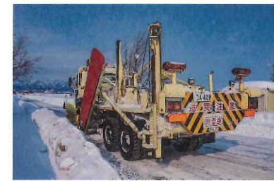
サイドウイング付きの除雪車は、前面のブラウで車道の除雪を行い、ウイング(Gブラウ)を広げて高さを調整し、歩道を除雪。これで車・歩道の除雪が一気に行えるという仕組みだ
