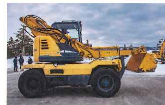
開発に8年かけたという1996年発売のコマツのホイール式油圧ショベル。このコンパクトで0.45tクラスである。走行時の車体サイズを小さくするためにアーム部分が折れ曲がる機構が斬新であった。車体色からすると2000年以降の製品と思われる
