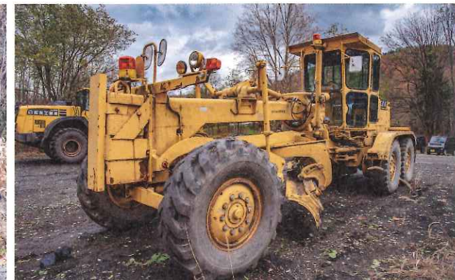
雪が降っても鉱山への道は公共の除雪が入らない。そのため作業員、作業用車両のための除雪も自前で行う。砂子炭鉱では旧タイプのロゴマークが入ったコマツのモーターグレーダGD605A-3が除雪用に重宝されていた
