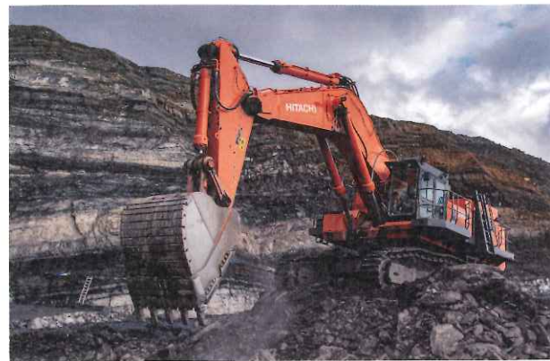
今号の表紙にもなった、日立建機の超大型油圧ショベル「EX1200」。炭鉱で稼働する重機は、一回の作業で多くの石炭を採掘する方が効率も高いため、基本的に大型の機種が使用される
