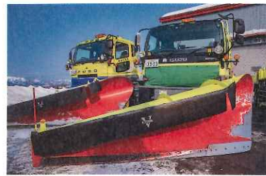
大型トラックのいすゞGIGA、FUSOスーパーグレートに協和機械製作所のワンウェイブラウを装着。道路を走行し、ブラウで削って雪を飛ばす。道路一往復で両車線の除雪が完了する
