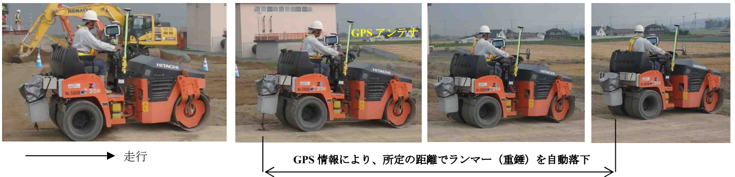
図-6 衝撃加速度法の自動化
