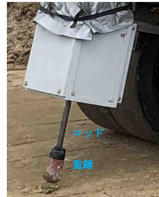
図-9 走行中の重錘とロッドの状態
