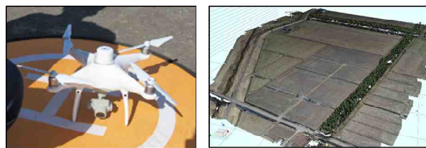
図 5 RTK-UAV（左）と解析点群データ（右）
