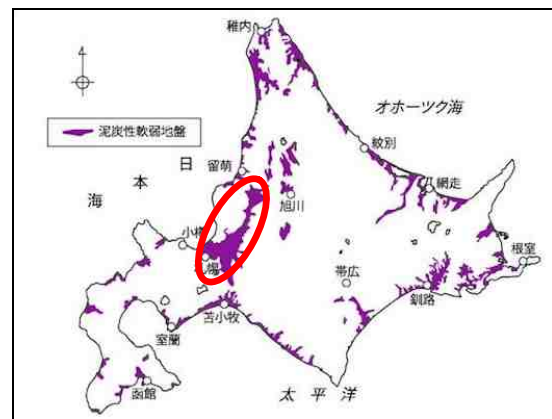
図2 北海道の泥炭性軟弱地盤分布図(『泥炭性軟弱地盤対策工マニュアル』より)
