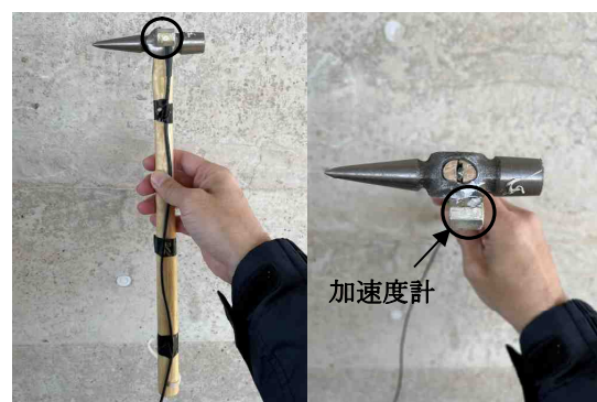
図-3 点検用ハンマーの加速度計
