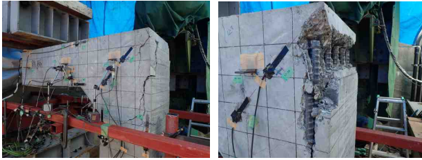
写真-3 隅角部破壊状況
