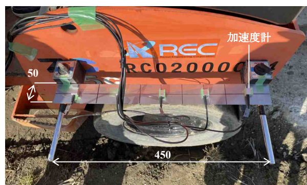
図-3 ローラー側面 加速度計の設置状況
