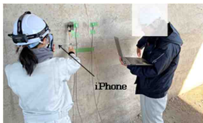
図-1 橋台における打音試験状況
