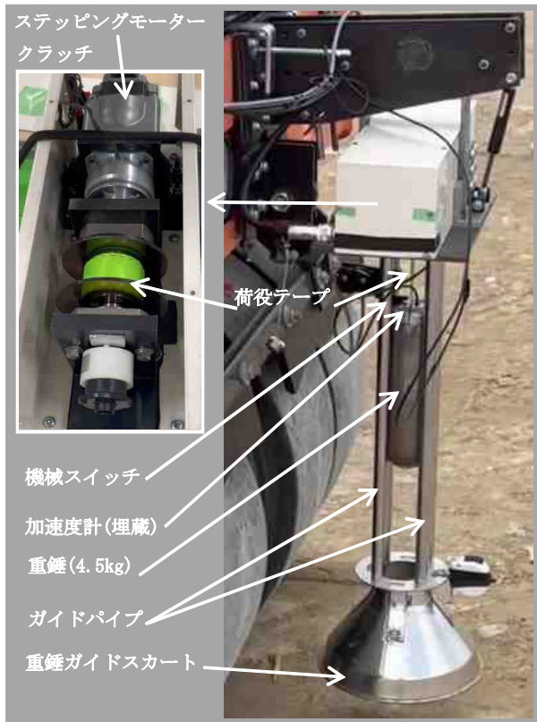
図-2 シーマルの機構概略
