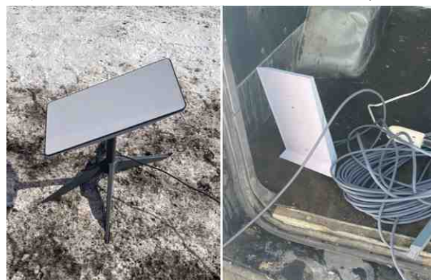
図 2: スターリンクアンテナ (左) とルーター (右)
