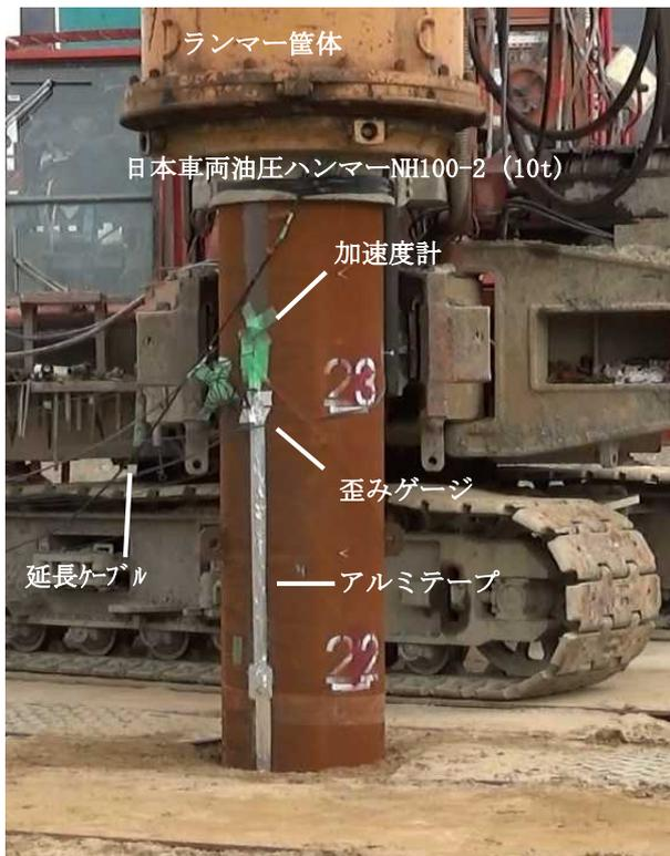
図-2 加速度計，歪みゲージ
