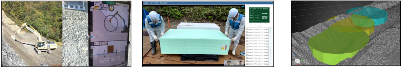
図 2: 左から ICT 建機への補正情報配信・不感地域における遠隔臨場・3D ネットワークプランニング
