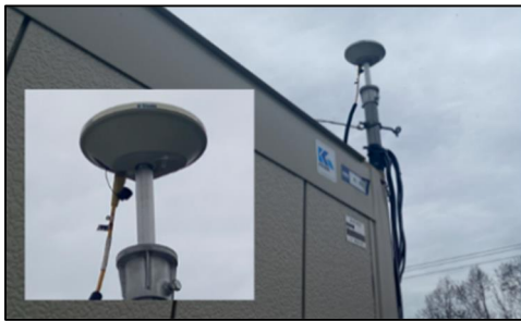
図 3 :現場事務所設置のオリジナル電子基準点
