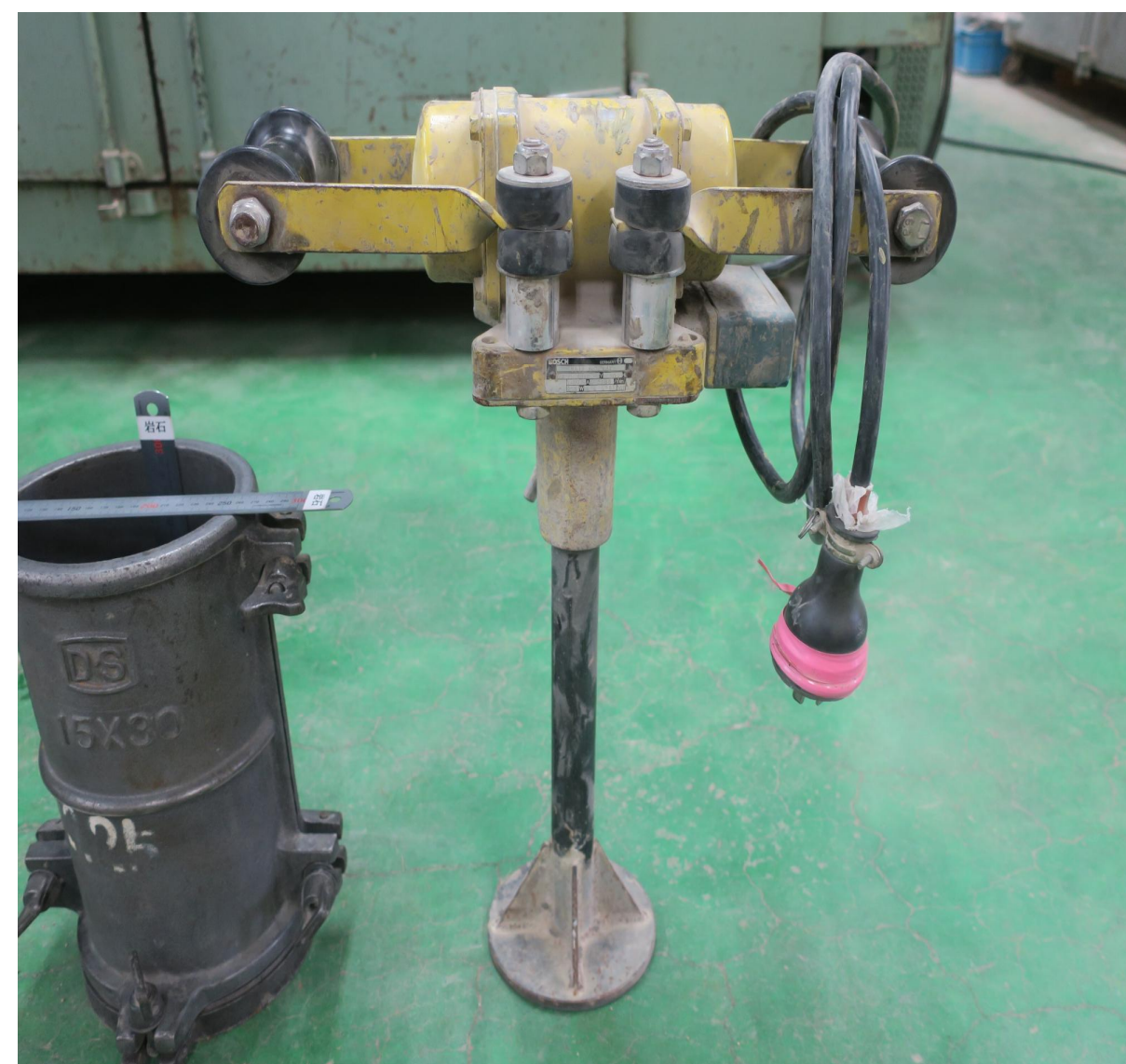
写真-7 振動締固め機
