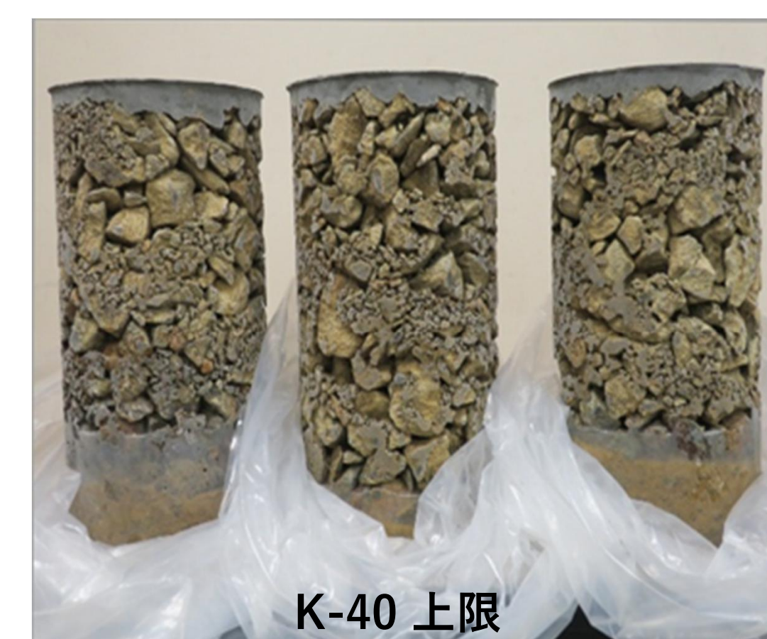
写真-9 凍結後の各供試体の状況
