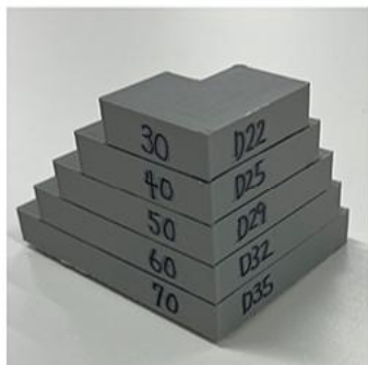
配筋検査ブロック
