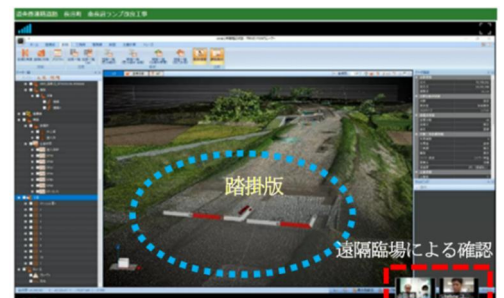
図- 3 デジタルツインを活用した現場検査
